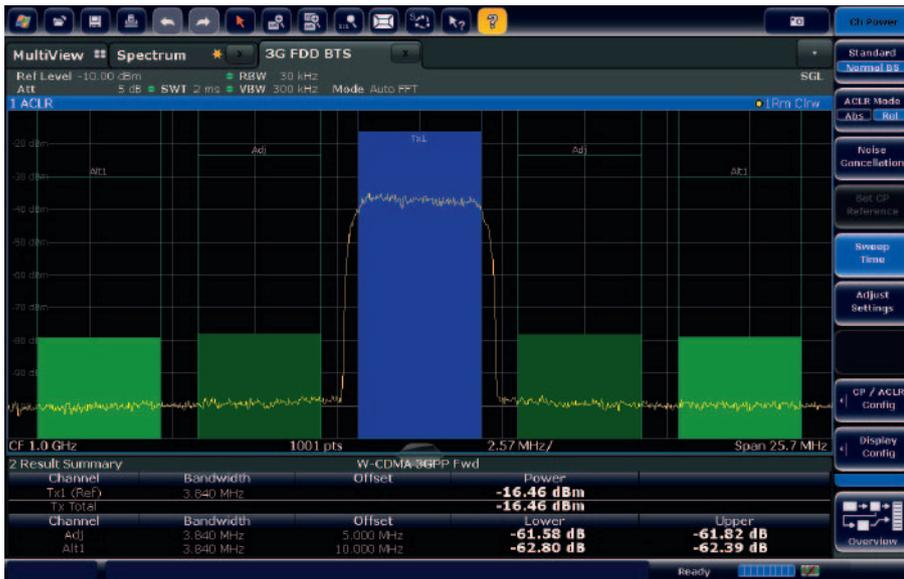
3GPP WCDMA信号的相邻信道泄漏比 (Adjacent Channel Leakage Ratio, ACLR) 测量。
