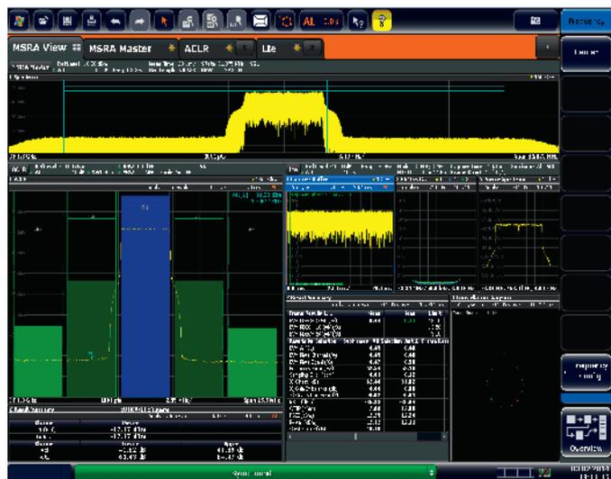
使用相同的IQ数据对两个LTE信号进行相互干扰分析的多界面显示。
