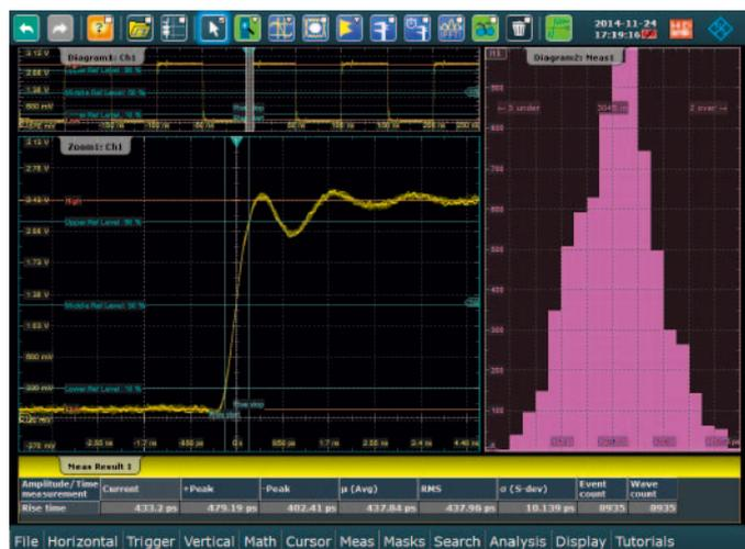
以统计（底部）、直方图和长期趋势显示的测量结果。
