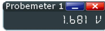
R&S®ProbeMeter：极高的直流测量精度，与仪器设置无关，能与通道测量同时进行。
