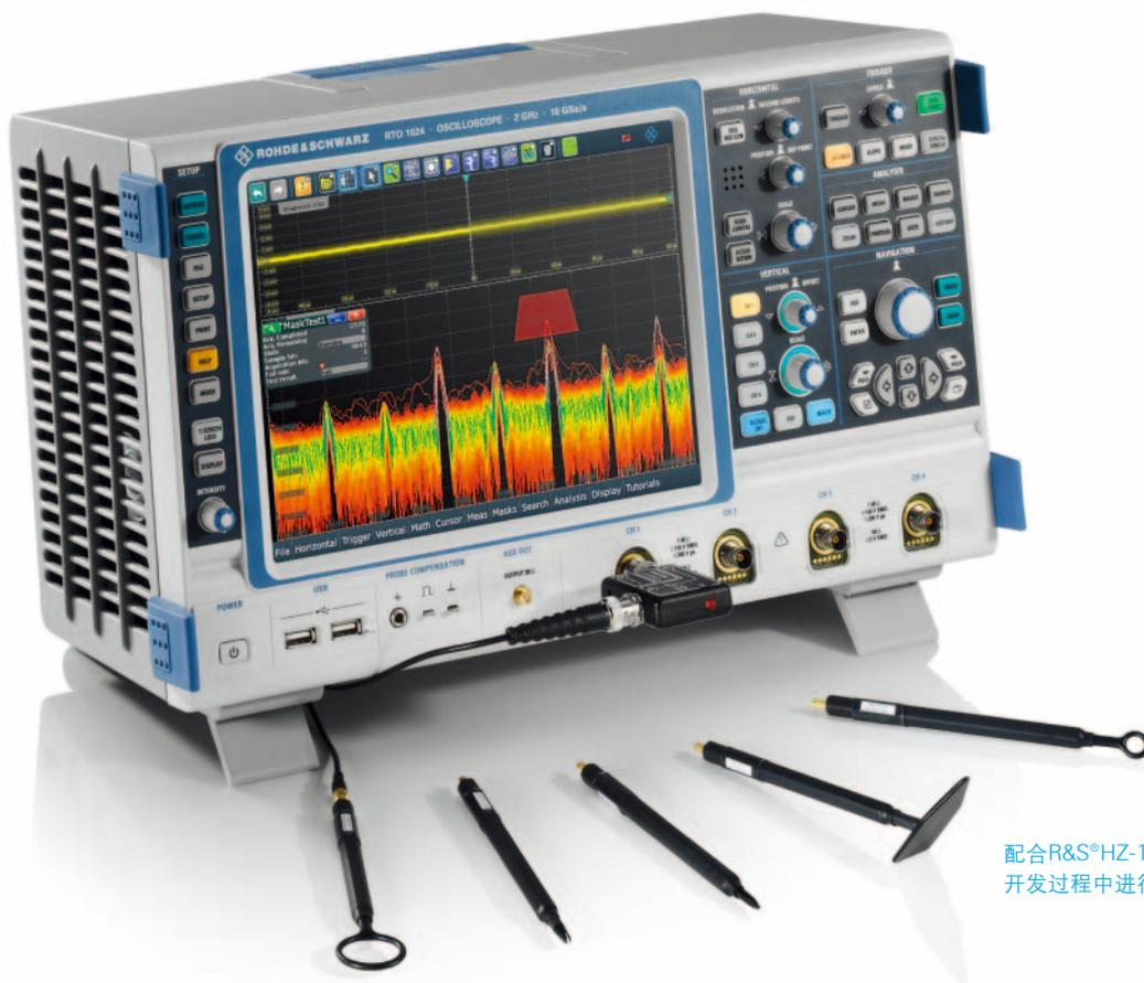
配合R&S®HZ-15近场探头，R&S®RTO示波器成为产品开发过程中进行EMI测试的理想工具。
