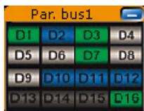
数字通道的信号状态在信号栏显示，与示波器的设置无关。
