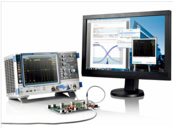
R&S®ScopeSuite软件可以在R&S®RTO示波器上运行。显示内容可以输出到示波器屏幕或外部监视器上。
