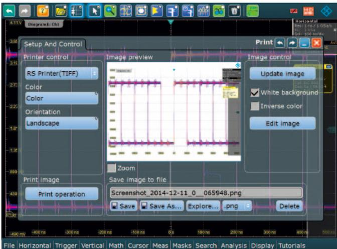
利用打印对话框可将内容归档，打印对话框提供了大量配置选项。
