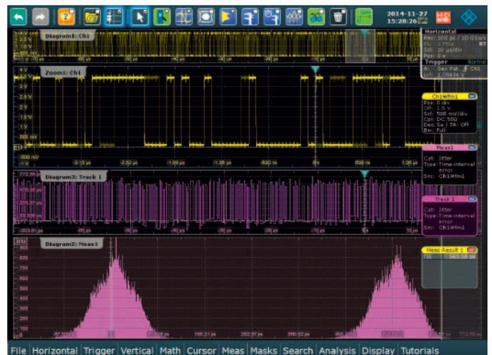
位序列 (010000X10000001) 基于恢复的嵌入式时钟的时间间隔误差 (TIE) 测量，下方的直方图显示不同的位序列TIE测量结果不同。
