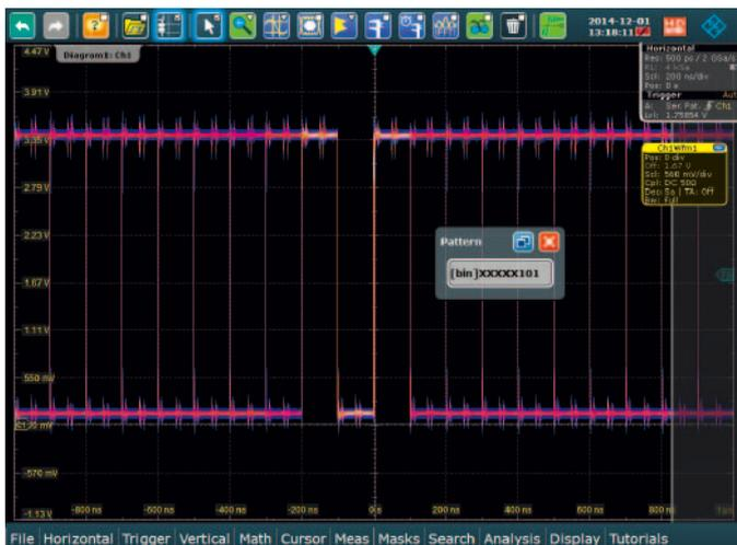
利用R&S®RTO-K13时钟数据恢复选件对特定序列的串行码型触发进行设置。
