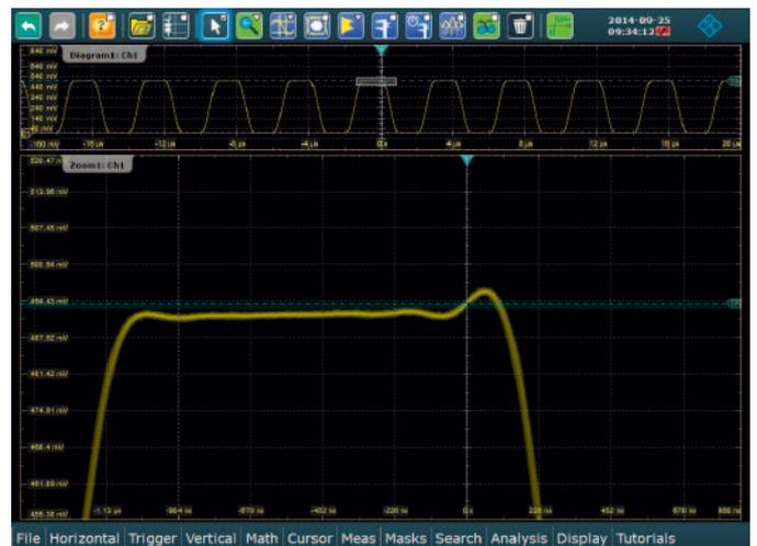
即使是这种0.4%过冲的信号细节，数字触发系统的独特架构也能实现稳定的触发（高分辨率模式选件）。
