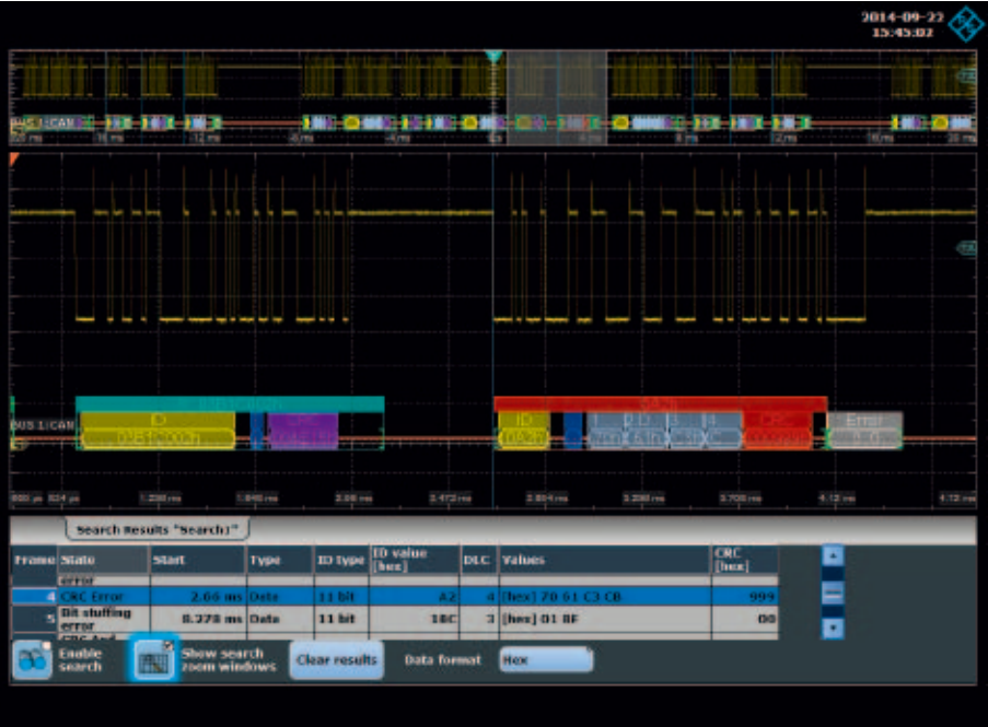
R&S®RTE搜索功能可用来确定串行协议中的错误。所有事件都列出一个表中，以便在不同事件之间导航。为了进行详细分析，可对所选事件进行缩放。
